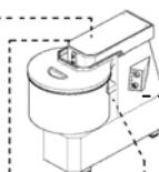
**Микровыключатель:** останавливает машину, когда поднимается головка. При последующем закрывании головки, запустить машину, нажимая кнопку I (только Мод.CNS-FN)
